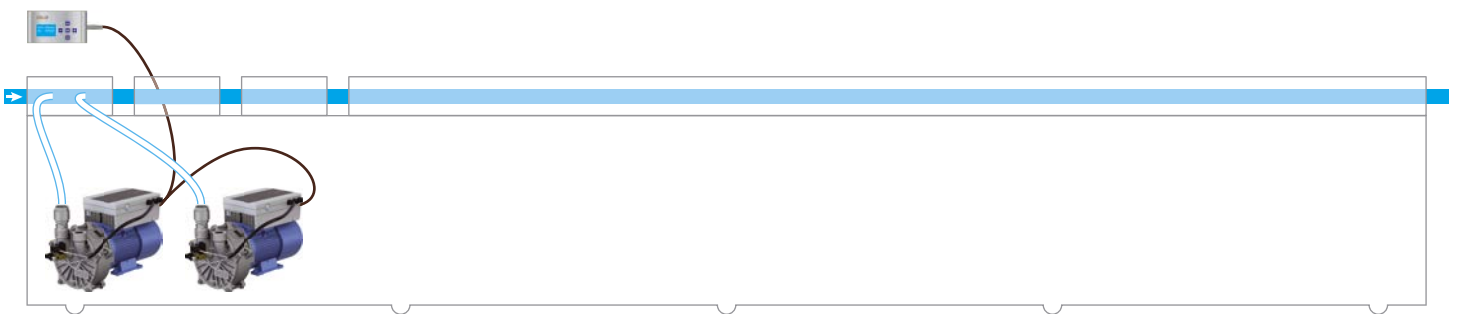
Installationsbeispiel für die Regelung eines Druckniveaus mit zwei Vakuumeinheiten mittels der Software-Funktion Master-Slave
